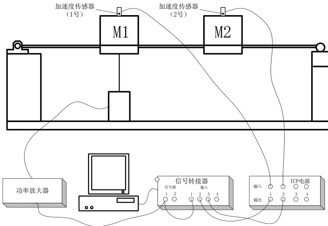
图 6—1 两自由度系统有阻尼受迫振动实验原理图
